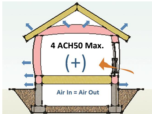
Pressurization Blower Door Test
