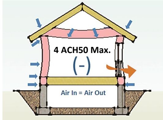
Depressurization Blower Door Test
